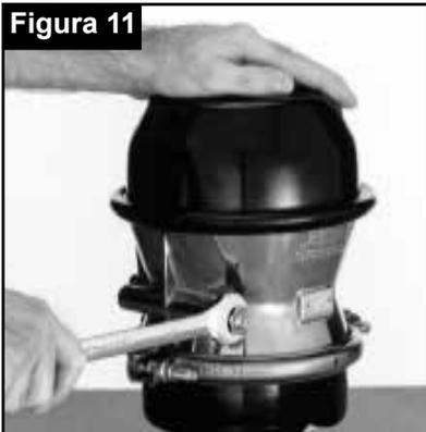
(j) Una vez purgada toda la presión de aire de la cámara, y aplicándose aún sobre el freno de resorte, quite la tuerca de seguridad, la arandela y el perno de seguridad en todos los modelos "TR". Reemplace estas piezas que se encuentran en sus respectivos compartimientos de almacenaje (Figura 4) en la cámara (o en la caja de herramientas del vehículo si la cámara no incluye ningún compartimiento de almacenaje) y apriete la tuerca contra la arandela plana aplicando un par motor de 10 libras/pies.
