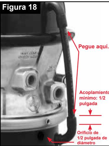
**IMPORTANTE:** Estas unidades deberán montarse junto con el CONDUCTO DE RESPIRACIÓN en la mitad superior de la cámara sin presión, alejadas de la superficie de rodado (Figura 10). Del mismo modo, el tubo del conector deberá pegarse o fijarse firmemente a los tubos acodados de caucho flexibles (Figura 14). El incumplimiento de estas instrucciones de instalación podría provocar la anulación de la garantía de MGM Brakes sin derecho a ningún tipo de reparación.
